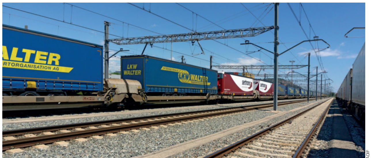
Vagones especializados P-400 de una autopista ferroviaria.
